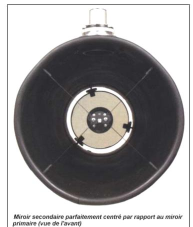
Les COLLIMATEURS LASERS sont très bien adaptés pour accomplir la deuxième étape soit d'aligner le centre optique du miroir secondaire sur le centre optique du miroir primaire. Lorsqu'on insère le laser dans le tube 1.25" du porte oculaire, la laser envoi son rayon sur le miroir secondaire qui lui, le réfléchit sur le miroir primaire. On remarque très souvent que le point réfléchi du laser sur le primaire arrive offset. Plusieurs facteurs expliquent ce qui peut se produire.
