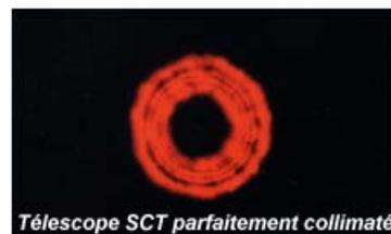
Un télescope SCT parfaitement collimaté devrait présenter un beau beigne comme le montre l'image de droite. Il faut y aller très lentement afin de ne pas perdre l'étoile. Il ne faut pas trop serrer les vis d'ajustement non plus pour ne pas endommager le mécanisme. On raffinerait ensuite la précision de la collimation sur le disque de diffraction de cette étoile mais grossie 500X.
