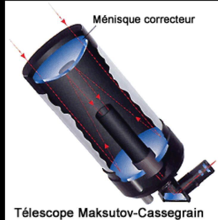
Encore un autre type de télescope. Celui-ci est très proche du principe optique du Schmidt-Cassegrain (S.C). Seules quelques différences les séparent.
