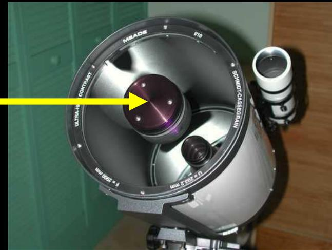
Cependant, même si le télescope « gagne » sur le plan du chromatisme, il se démarque sérieusement de la lunette à cause de **l'obstruction formée par la présence du miroir secondaire.**
