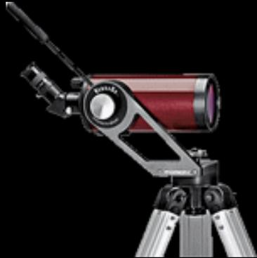
Le principe de la monture azimutale repose sur deux axes : **l'azimut** (gauche-droite) et **l'altitude** (haut-bas). Ce type de monture est simple à manipuler tout en étant peu encombrant. Cependant, sauf dans le cas de motorisations complexes (sur deux axes), le suivi céleste ne peut s'effectuer que manuellement.
