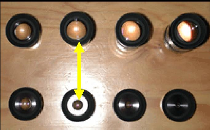
Un paramètre à prendre aussi en compte est la **lentille d'œil** (associée à son dégagement oculaire). **Plus elle est grande, plus il est facile d'observer sans être collé à l'oculaire.** Cela est bien pratique pour les porteurs de lunettes. **A ne pas confondre avec la pupille de sortie, diamètre de la projection sur la lentille d'œil.**
