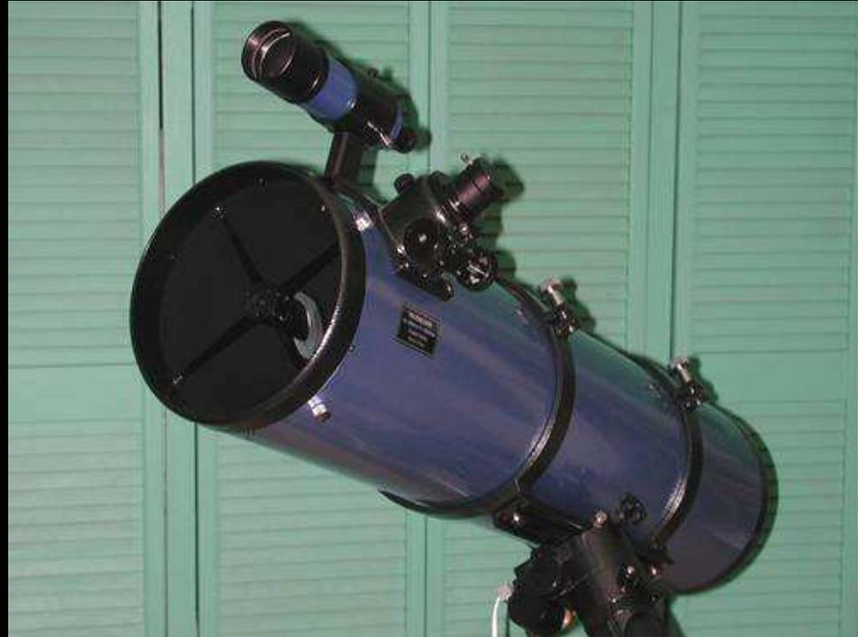
Cependant, l'avantage indéniable du télescope de Newton comparé à la lunette, c'est le faible coût de fabrication d'un grand objectif.
