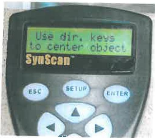
Pour faire cela rapidement, il est conseillé de changer la vitesse de déplacement de la monture (en utilisant la touche Rate) pour la remplacer par une vitesse plus rapide (genre Rate 6 par exemple).
