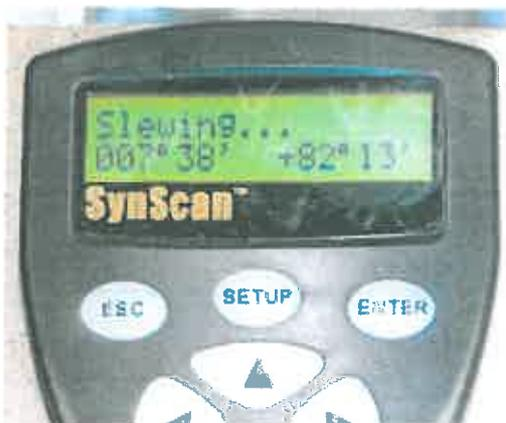
Il se peut que le telescope vise relativement loin de l'étoile, c'est normal... En général pour moi, la première étoile n'est même pas dans le champ du chercheur. On utilise alors les flèches de direction de la raquette pour centrer l'étoile dans le chercheur, puis ensuite la centrer dans l'oculaire.
